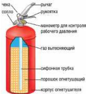
Устройство, заряженное огнетушащим порошком и закачанное газом (воздухом, азотом или углекислым газом).
